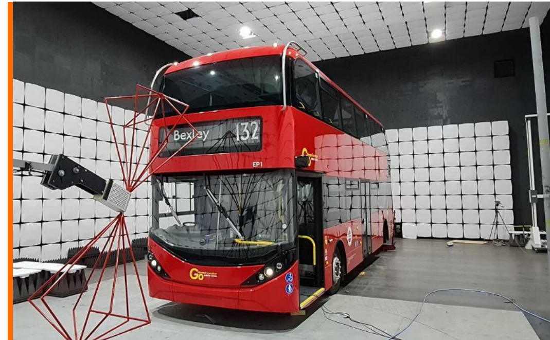
Autobús eléctrico de dos pisos, ensayado en nuestra cámara de ensayos de EMC para vehículo completo en Reino Unido.
