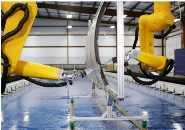
Arcadia Aerospace Industries, une division d'Arplus+ Laboratories USA, fournit des solutions NDI économiques, rapides et de grande qualité pour les matériaux métalliques et composites. Nous sommes spécialisés dans le développement d'équipements automatisés NDI sur mesure pour les fabricants dans l'aéronautique et le spatial.
